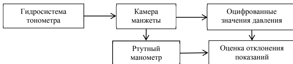
Рис. 3. Схема проверки значений давления в манжете
